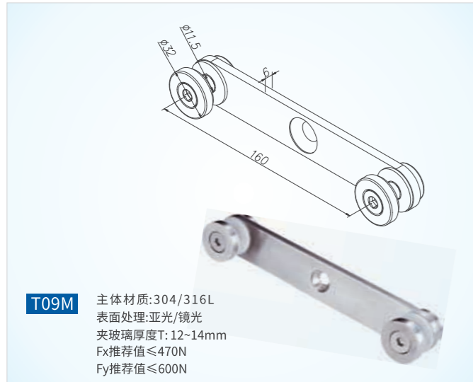
T09 主体材质:304/316L 表面处理:亚光/镜光 夹玻璃厚度T: 12~14mm Fx推荐值 \leq 470N Fy推荐值 \leq 600N
