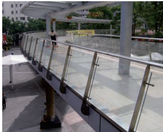
LT19M 主体材质:CF8/CF8M 表面处理:亚光/镜光 夹玻璃厚度T: 12~17.5mm Fx推荐值≤1200N Fy推荐值≤650N
