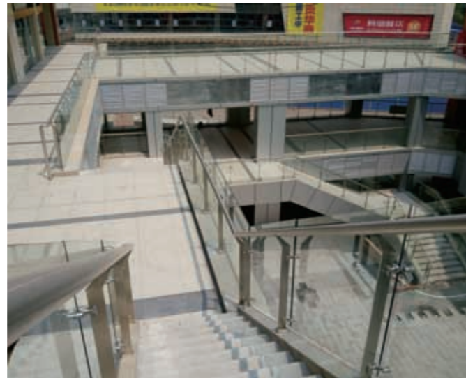
LT19 主体材质:CF8/CF8M 表面处理:亚光/镜光 夹玻璃厚度T: 12~17.5mm Fx推荐值≤1200N Fy推荐值≤650N
