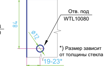
Монтажные отверстия в стекле под коннекторы WWB11030
