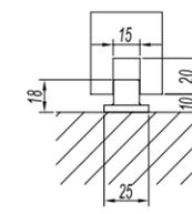
门底导向件安装尺寸图
