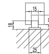
门底导向件安装尺寸图
