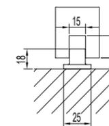
门底导向件安装尺寸图
