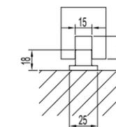
门底导向件安装尺寸图
