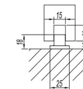
门底导向件安装尺寸图
