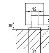
门底导向件安装尺寸图
