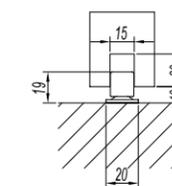
门底导向件安装尺寸图
