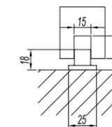
门底导向件安装尺寸图
