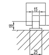
门底导向件安装尺寸图
