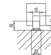
门底导向件安装尺寸图
