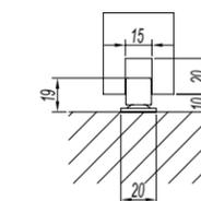
门底导向件安装尺寸图
