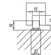
门底导向件安装尺寸图
