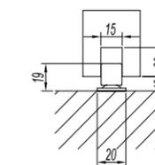
门底导向件安装尺寸图
