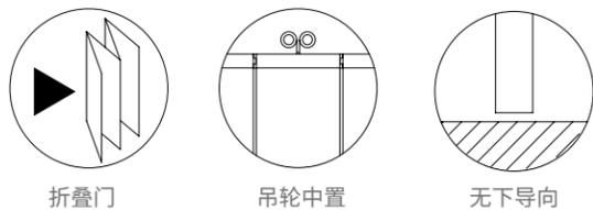
折叠门 吊轮中置 无下导向
