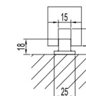
门底导向件安装尺寸图
