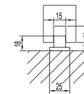
门底导向件安装尺寸图
