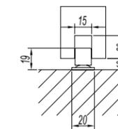
门底导向件安装尺寸图
