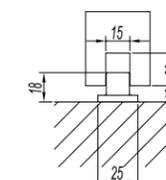
门底导向件安装尺寸图
