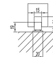
门底导向件安装尺寸图
