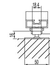
门底导向件安装尺寸图
