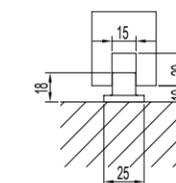
门底导向件安装尺寸图
