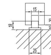
门底导向件安装尺寸图
