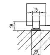
门底导向件安装尺寸图
