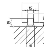
门底导向件安装尺寸图
