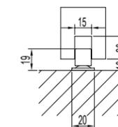
门底导向件安装尺寸图
