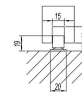
门底导向件安装尺寸图
