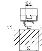
门底导向件安装尺寸图
