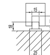
门底导向件安装尺寸图
