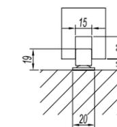
门底导向件安装尺寸图
