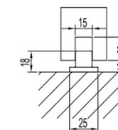
门底导向件安装尺寸图
