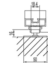
门底导向件安装尺寸图
