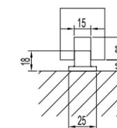
门底导向件安装尺寸图
