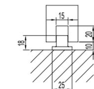
门底导向件安装尺寸图
