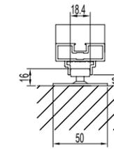
门底导向件安装尺寸图
