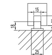
门底导向件安装尺寸图
