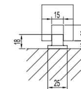
门底导向件安装尺寸图
