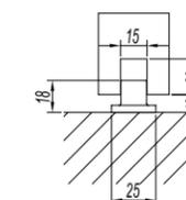
门底导向件安装尺寸图
