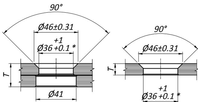
\*- Предельно допустимые размеры отверстия с учетом предельных отклонений:
