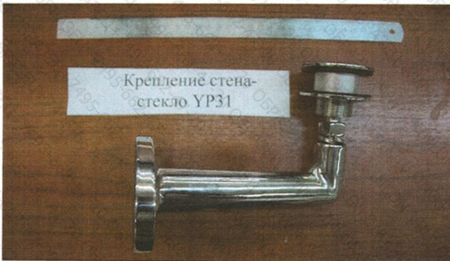
Рис. 3. Образец перед испытанием. Схема нагружения (F x )
