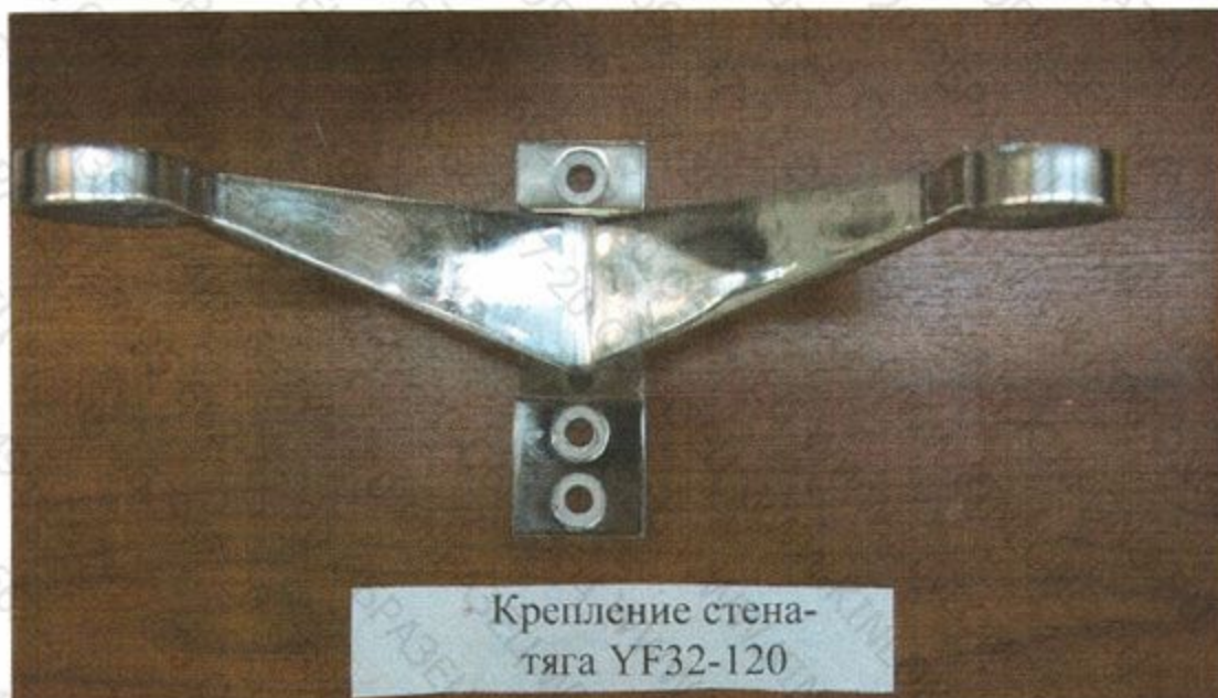
Рис. 3. Образец перед испытанием. Схема нагружения (F x )
