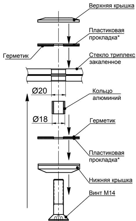
\* В месте сопряжения со стеклом пластиковая прокладка промазывается герметиком.
