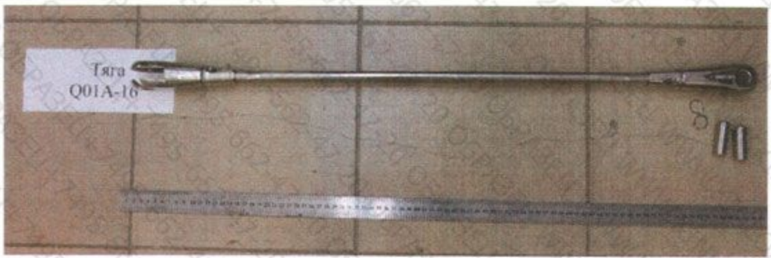
Рис. 3. Тяга в сборе с наконечниками Q01A-16 перед испытанием
