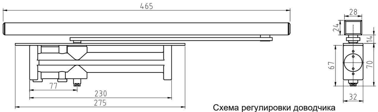
Схема регулировки доводчика
