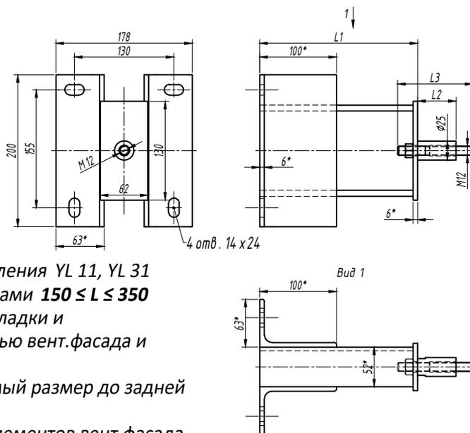
**L** - Вылет кронштейна до плоскости установки крепления YL 11, YL 31 (Кронштейн козырька). Регламентирован размерами  $150 \leq L \leq 350$  (Необходимо учесть толщину изоляционной прокладки и технологический зазор между передней плоскостью вент. фасада и задней плоскостью крепления YL 11, YL 31).
