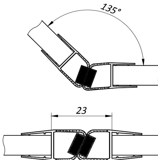
Возможна установка при повороте элементов кабины при углах 135 или 180°.
