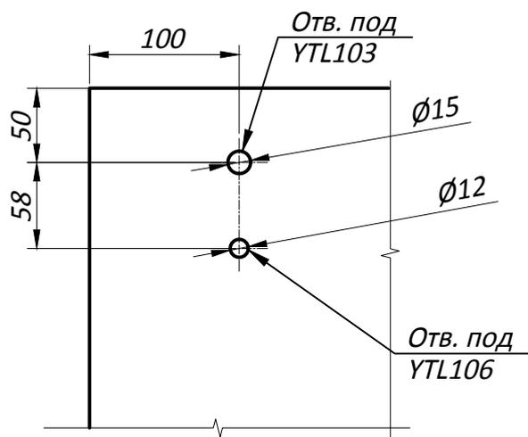
**Типовая монтажная схема**
