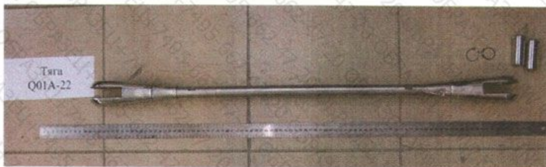
Рис. 3. Тяга в сборе с наконечниками Q01A-22 перед испытанием
