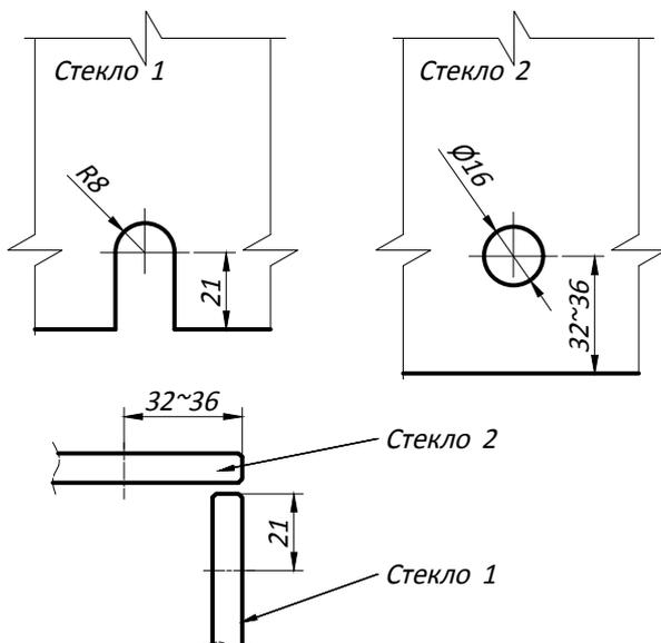
**Типовая монтажная схема**
