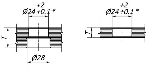
\*- Предельно допустимые размеры отверстия с учетом предельных отклонений:
