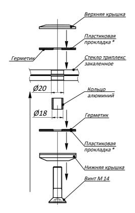
\* В месте сопряжения со стеклом пластиковая прокладка промазывается герметиком.
