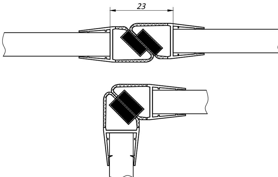
Возможна установка при повороте элементов кабины при углах 90 или 180°.
