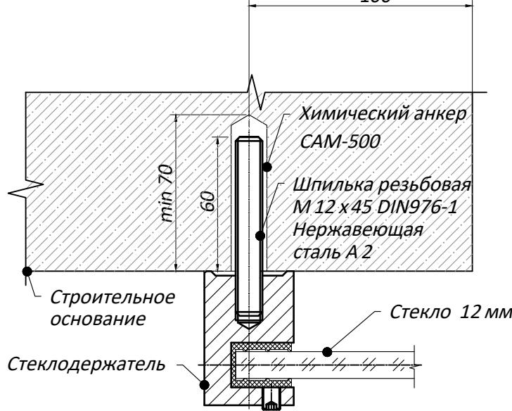
**Типовая монтажная схема**
