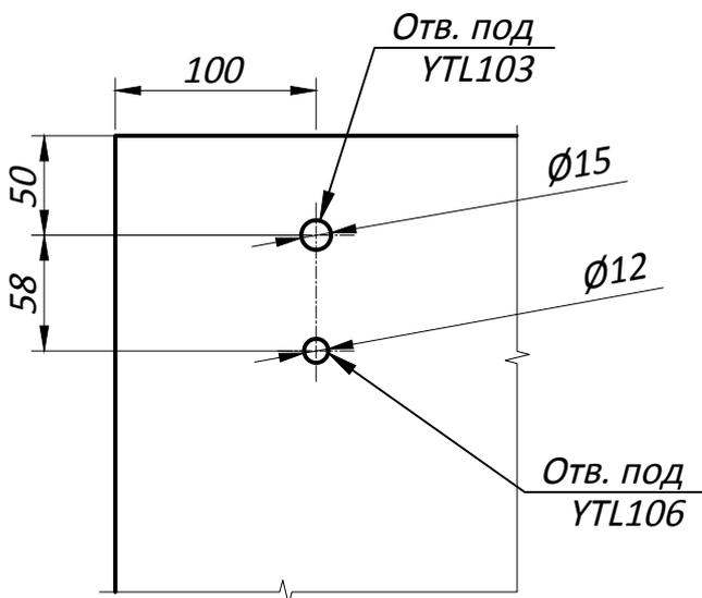
*Типовая монтажная схема*
