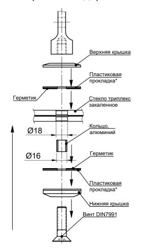
В месте сопряжения со стеклом пластиковая прокладка промазывается герметиком.
