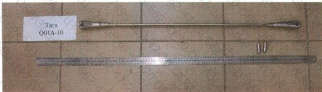
Рис. 3. Тяга в сборе с наконечниками Q01A-10 перед испытанием
